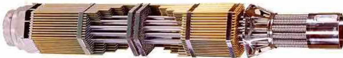
Рис. 1.4. Збірка твелів для реактора типу ВВЕР
